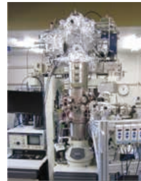
本研究グループで開発した世界初のスピン偏極透過電子顕微鏡
